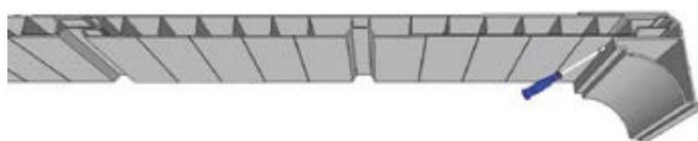
Imagem 04 – Ilustrativa – Tipo – Encaixe de Forro para dilatação.
